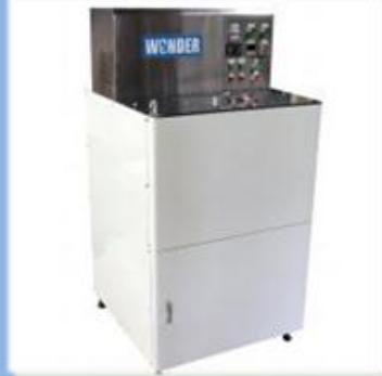
廃食用油再生燃料化(BDF)装置「ワンダー100」
