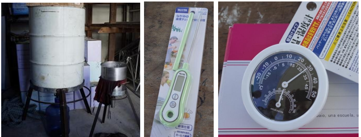
写真) 酸化値判定用試験紙(上)、現地で製作されたタンクと漏斗(左)、家庭用油温計(中央)と、気温・湿度計(右)
