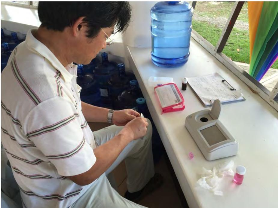
図 4-36 化学的酸素要求量 (COD) 及びアンモニア性窒素のデジタル測定
