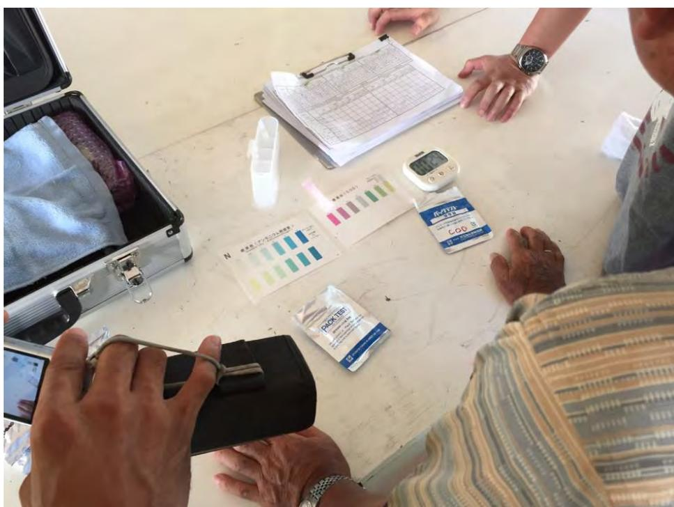
図 4-35 化学的酸素要求量 (COD) 及びアンモニア性窒素のパックテストによる測定
