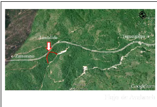
Foto H3.1: La escala del deslizamiento es de aproximadamente 200m de ancho y 120m de profundidad. En su curso inferior corre la quebrada Cuevitas.
