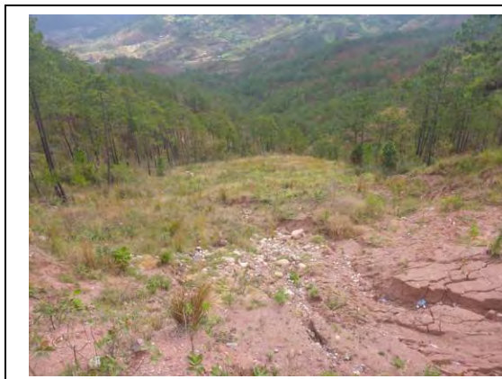
Foto H2.2: Situación de deslizamiento Toma desde la parte superior Se deduce el ancho del deslizamiento 60m, longitud de 150m. (Mar. 6, 2015)
