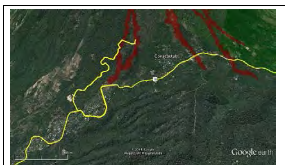
Foto 4.2.10: Derrumbes recientes descifrados desde las imágenes, territorios alcanzados por derrumbes en color rojo (Suministro por el profesor de Niigata Fukuoka, Hiroshi)
