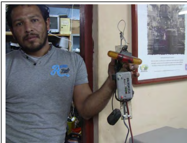
N8. 6: 河川水位センサーの信号、数字が水位の高さを示す。グアテマラ国 CONRED が技術指導。
