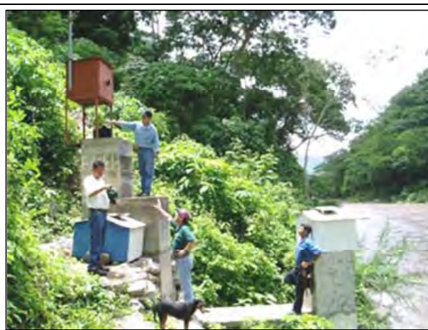
写真 H9.4: 洪水早期警戒システムの降雨観測所 出典：CCIVS 資料「Comisión para el Control de Inundaciones del Valle de Sula」
