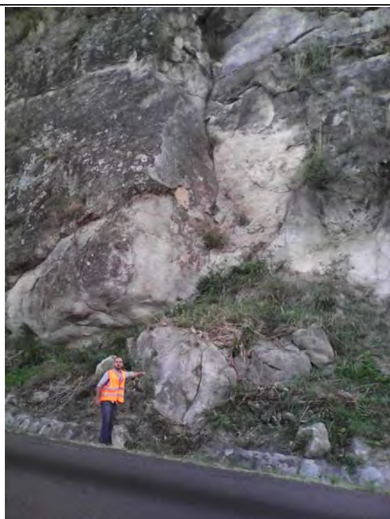
写真 N2.9: 道路山側の転石 最大級 2.0m x 2.0m x 1.2m (2015/6/2)
