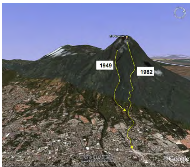
図 4-2-4 サンサルバドル火山 メヒカノス・ラス・ラハス溪流における土石流災害の履歴 (1949年、1982年の土石流流下経路)
