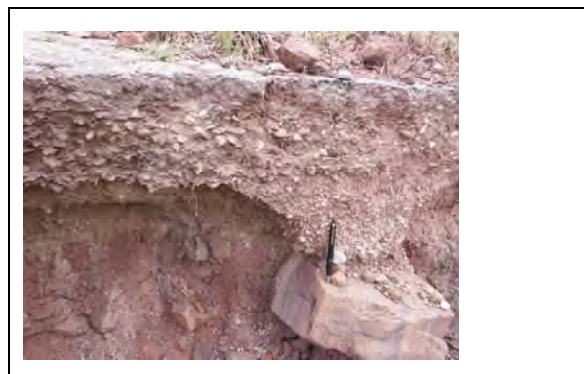
写真 4.4.2: 同左 滑落崖に認められる火山性岩屑の盛土
