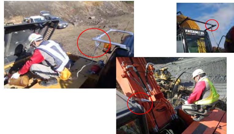
Prévention de chute pour le travail en hauteur de réparation/entretien (Harnais de sécurité)
