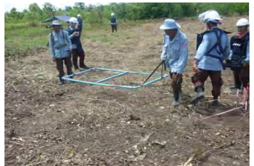
UXO 探知機（ラージループ）は地雷・不発弾除去活動後の最終確認及び、UXO の探知にも不可欠であり、必要性が高い
