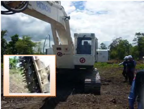
ブラッシュカッター。ロータリー部のカッターの摩耗は激しい
