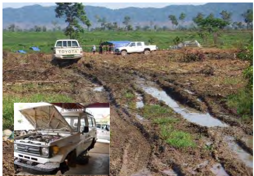
雨期における軟弱地走行や、凸凹の大きい土道走行などが避けられなく車輛への負荷が大きい
