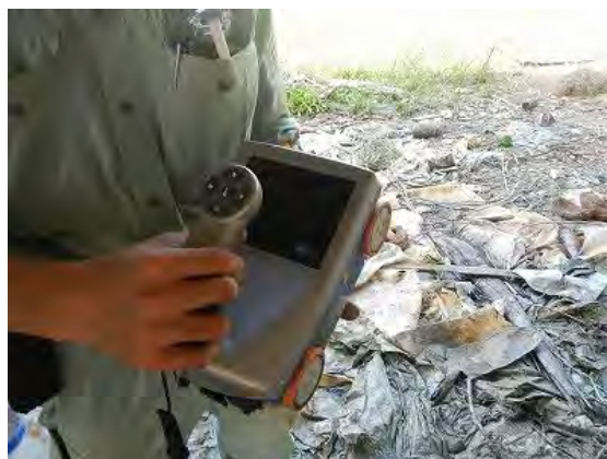
ပုံ (၃.၇) ။ သံချောင်းစစ်ဆေးသည့်စက် (Radar System)
