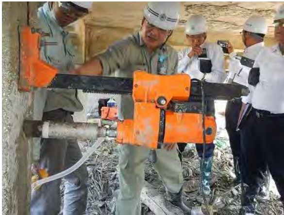
ပုံ (၃.၆) ။ Core Drilling အသုံးပြုပုံ ပြသနေပုံနှင့် သင်တန်းသားများ လက်တွေ့လုပ်ဆောင်ကြည့်နေပုံ
