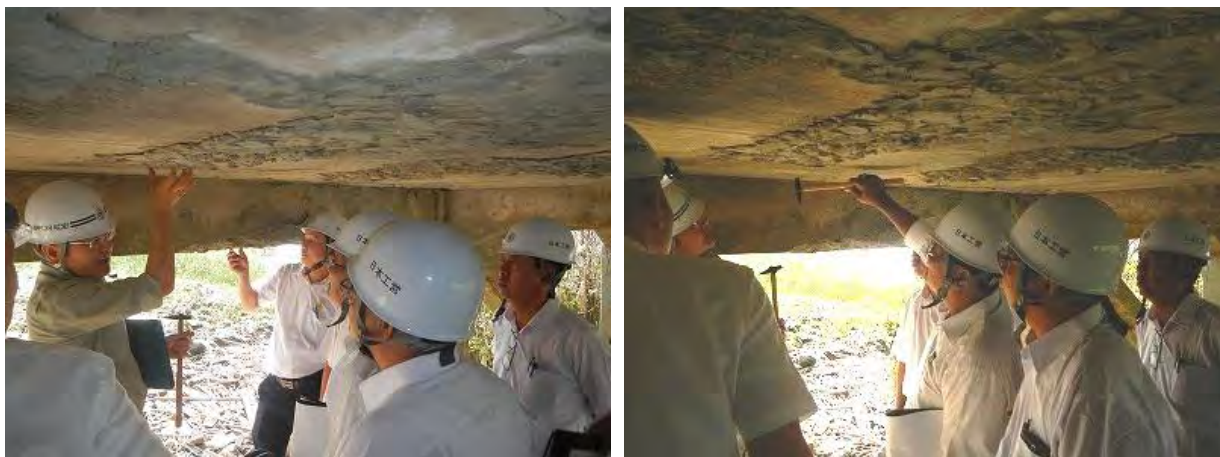
写真 3.16 打音調査の説明と受講者の打音状況
