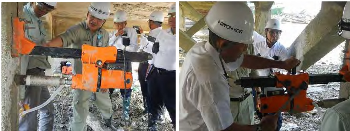
写真 3.18 コアドリル使用方法説明と受講者によるコア削孔状況
