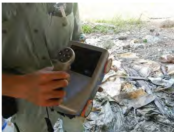
写真 3.19 鉄筋探査機（電磁波レーダ法）
