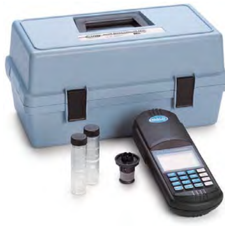
◇ポータブル吸光光度計 (HACH 製 DR890)
