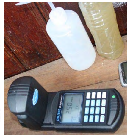
◇ポータブル吸光光度計 (HACH 製 DR890)
