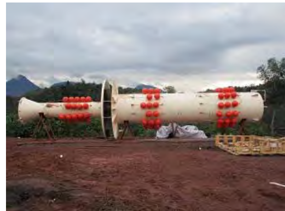
深層曝気装置組立完了
