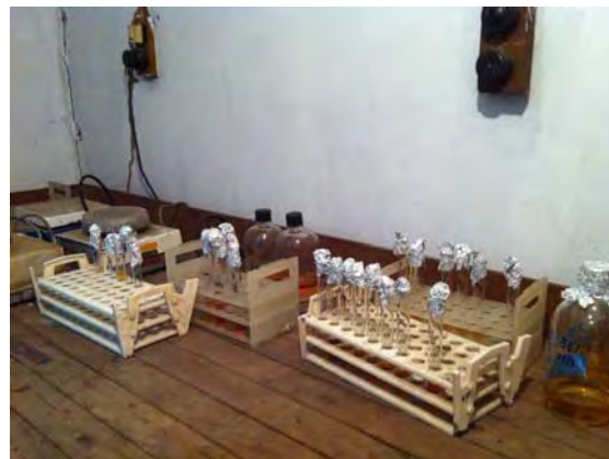
No. 4 現在の国立口蹄疫研究所。ウイルスを培養するための恒温室。ウイルスの封じ込めが考慮されていない。
