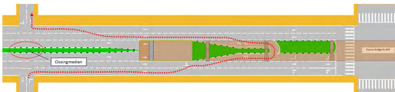
Figure 3.6.29 中央分離帯の閉鎖による横断交通遮断とその迂回路
