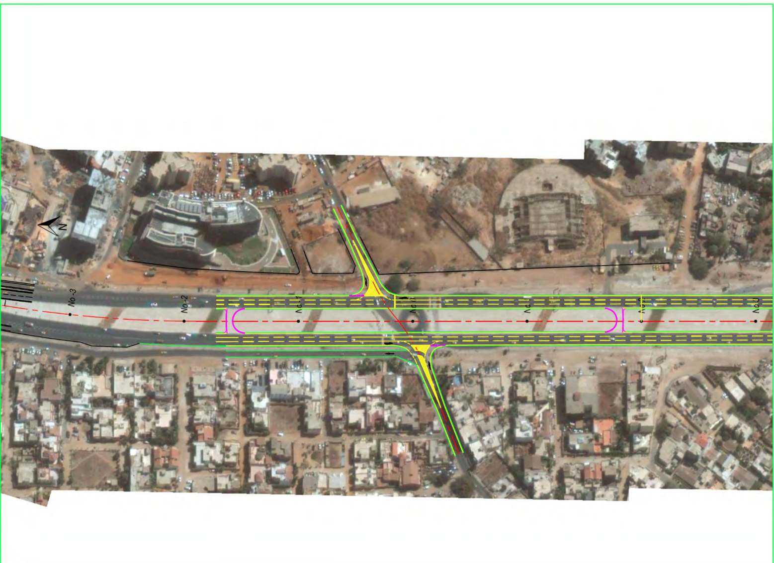
Figure 12.5.12 Amélioration au niveau du sol avec des voies en U au niveau de Cité Keur Gorgui (I-02f)
