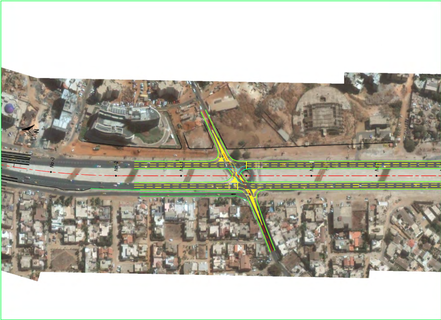
Figure 12.5.11 Amélioration au niveau du sol avec des feux de signalisation au niveau de Cité Keur Gorgui (I-02e)
