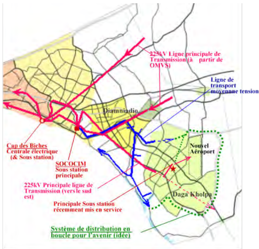
Figure 7.7.4 Concept préliminaire du système d'approvisionnement en électricité de la zone Daga-Kholpa
