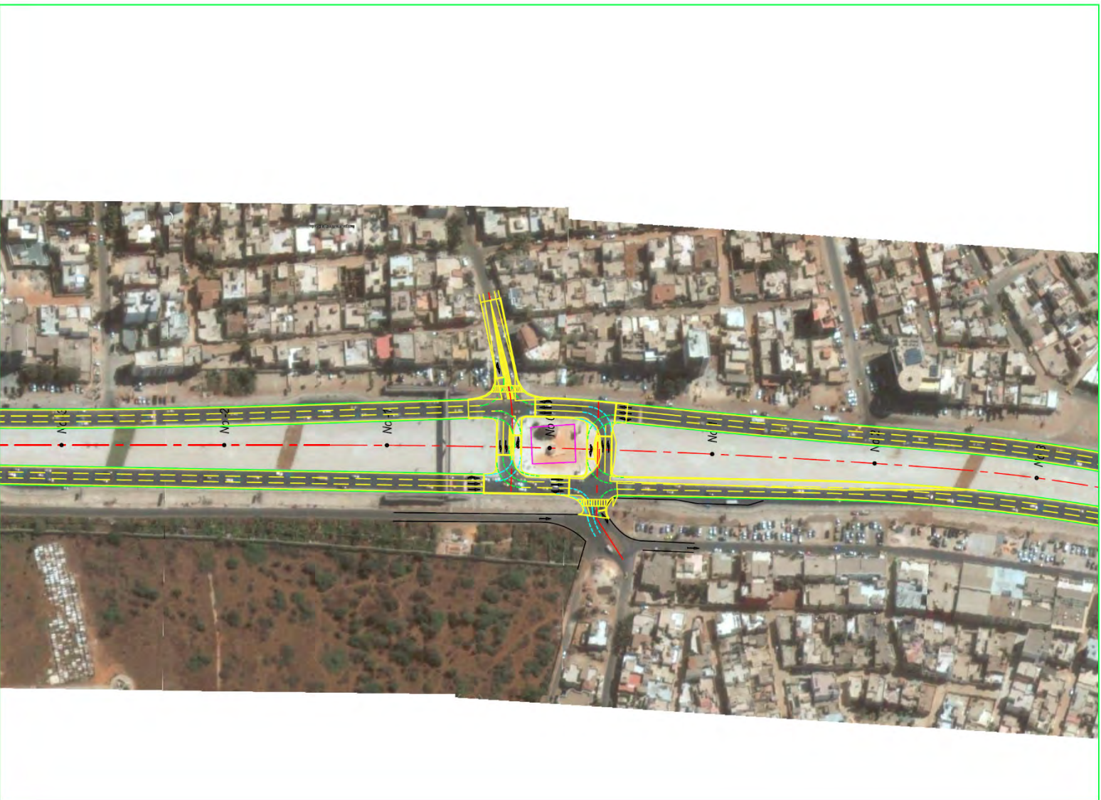
Figure 12.5.5 Amélioration au niveau du sol avec des feux de signalisation au niveau de SDE (I-01e)
