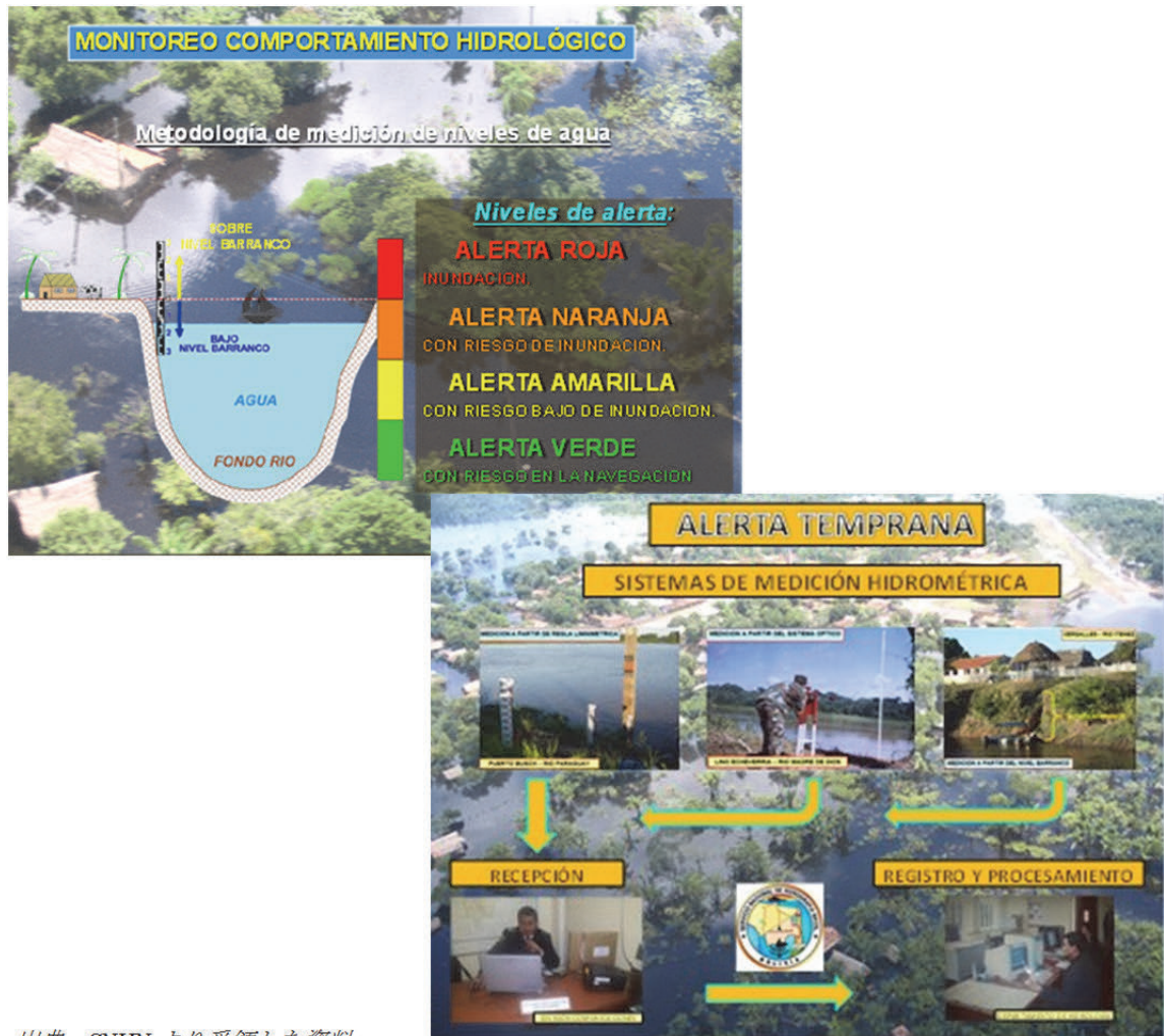
図 3.2.6 洪水予警報の基準水位と情報伝達洪水予測 (ベニ県)
