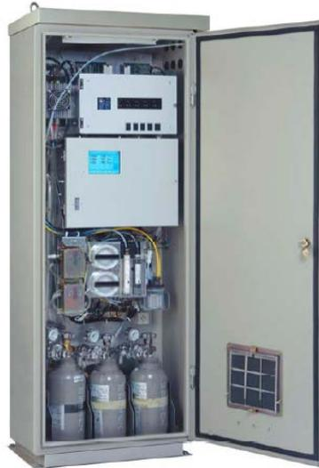
图 2-3 烟道烟气自动分析仪（非分散红外线吸收法）
