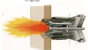
图 3-26 浓淡燃烧器的外形及原理图 (燃气、燃油用)
