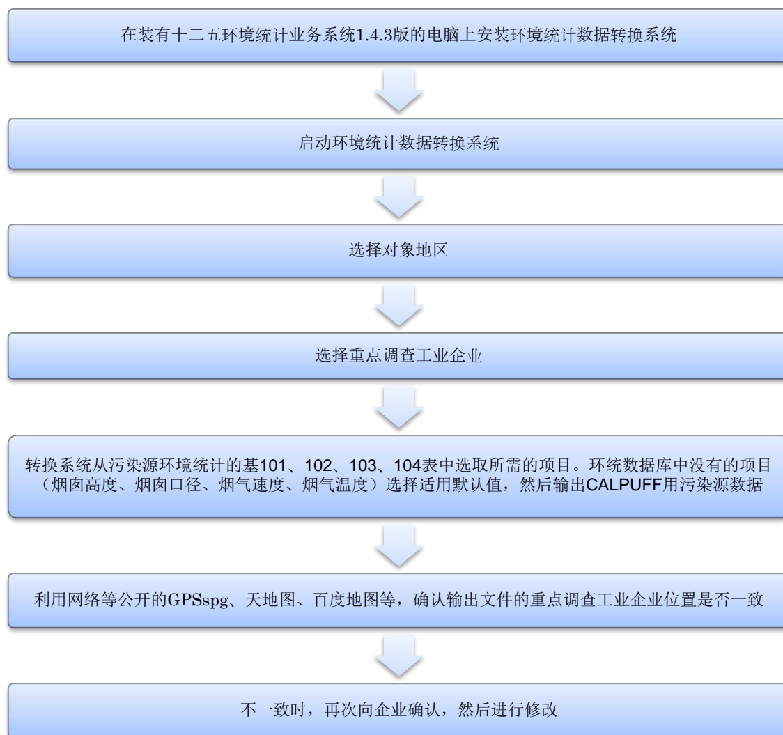
图 3.3-1 重点调查工业企业污染源排放清单制作流程（简易方法）
