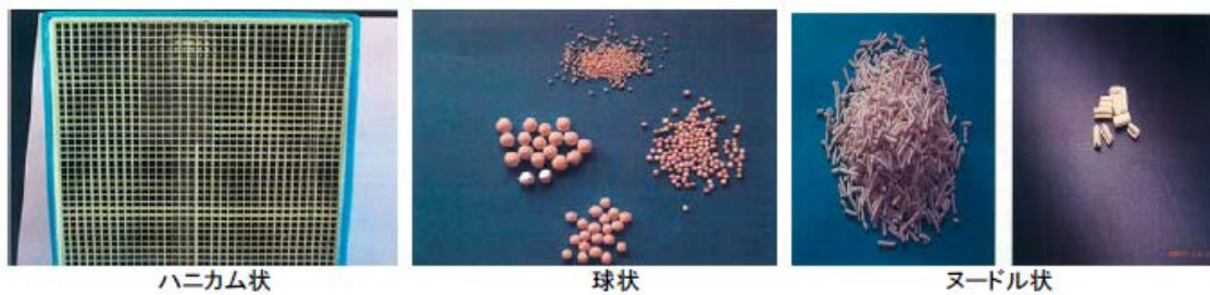
図 3-34 各種形状の脱硝触媒の事例 (出典：堺化学)
