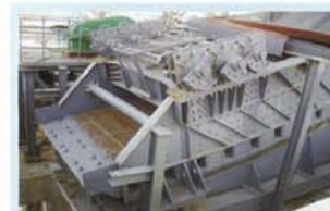
上振式三轴驱动椭圆等厚振动筛
