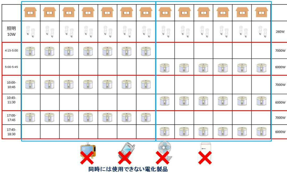
図 35 雨季における電気消費量の多い電化製品の利用イメージ
