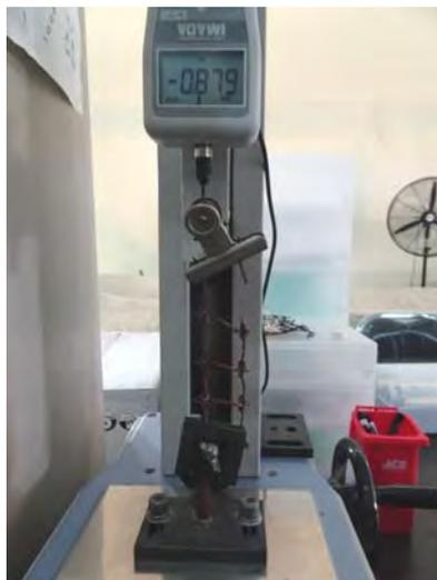
写真 48 藁ネットの引張強度測定状況
