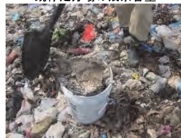
転圧後のごみの単位堆積量の測定
