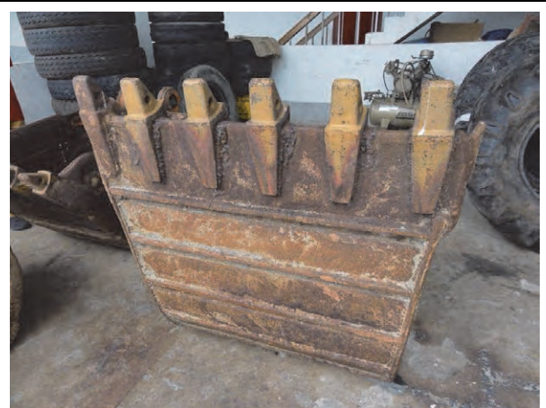
エクスカベーター バケットの補強溶接
