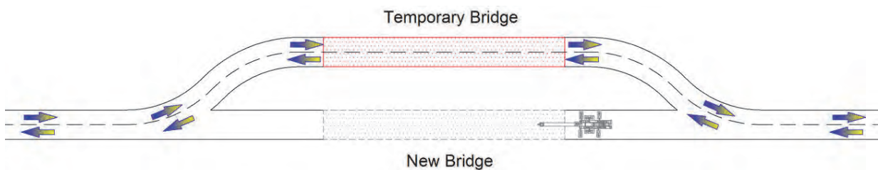
(a) 仮設橋による迂回路（B 区間）
