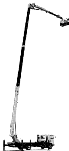
図 10.7.1 高所作業車による目視点検
