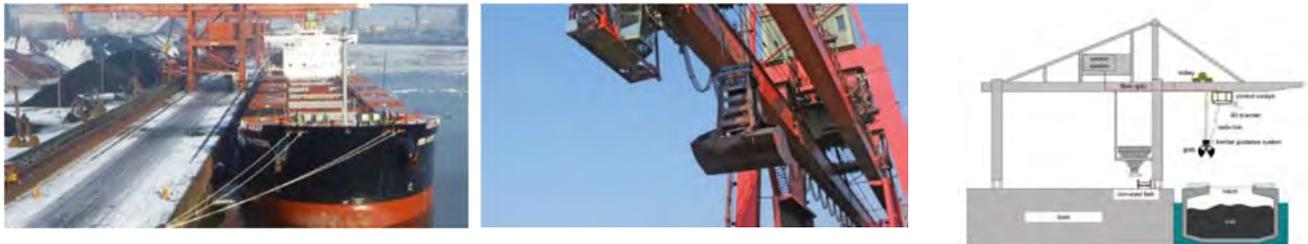
全自動のバルク貨物荷卸機は一般に、3D レーザースキャナー、内地ナビゲーションシステム、および物理的状態（船舶などの寸法や位置）を精巧に測定し、荷卸機に指示を与える工業用コンピューターシステムを備えている。
