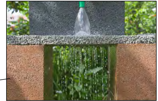
BÊ TÔNG THẨM
