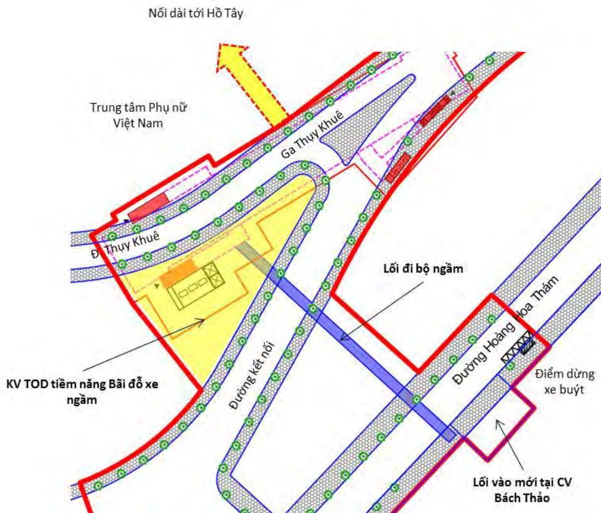
Hình 4.2.6-2 Khu vực TOD tiềm năng kết nối với ga và lối đi bộ ngầm
