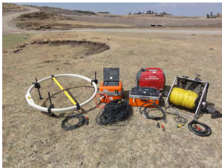
図 4.3.5: TEM 測定システム
