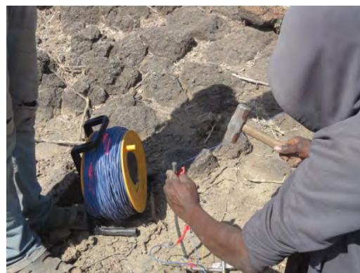
(b)VES 電流電極打ち込み
