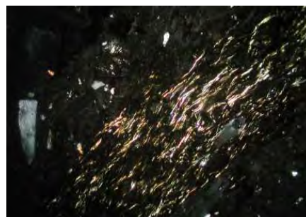
溶結部に粘土鉱物が形成されている。この雲母状の粘土鉱物は方解石のように早くは形成されないであろう。それゆえこの岩石はある程度古いものと考えられる。
