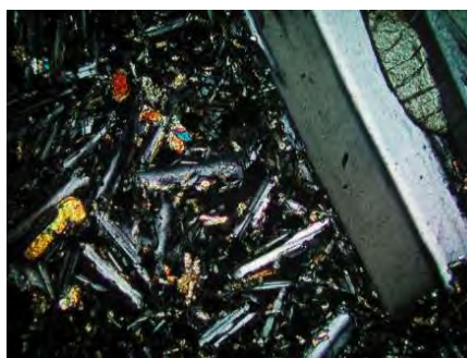
石基は微粒な長石、不透明鉱物および輝石からなる。斜長石の斑晶には縞模様の双晶がある。
