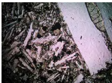
石基は微粒な長石、不透明鉱物および輝石からなる。斜長石の斑晶には縞模様の双晶がある。
