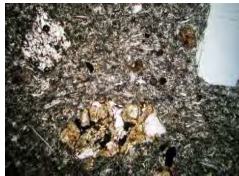
火山ガラスの破片からなる基質に、軽石・アルカリ長石 (劈開あり) ・流紋岩の破片
