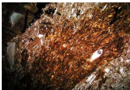
溶結部に粘土鉱物が形成されている。この雲母状の粘土鉱物は方解石のように早くは形成されないであろう。それゆえこの岩石はある程度古いものと考えられる。
