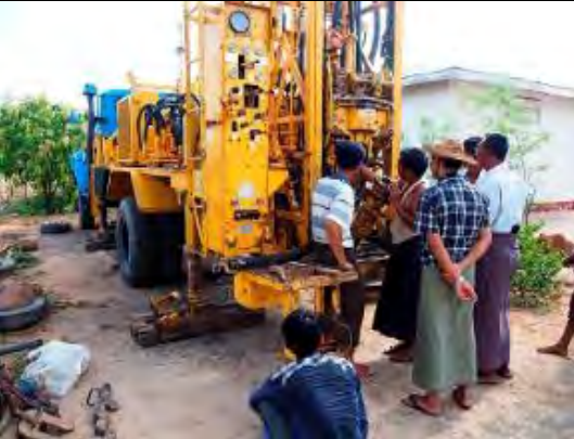
写真-9: ニャンウーワークショップにおける整備状況。工事終了後、回転部の分解・掃除・注油等の点検整備を実施
