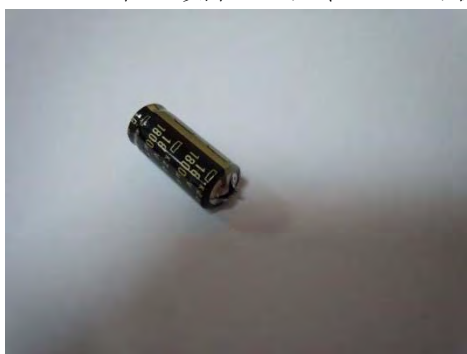
破裂した電解コンデンサの例
