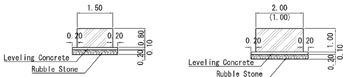
RTG 走行部基礎コンクリート断面
