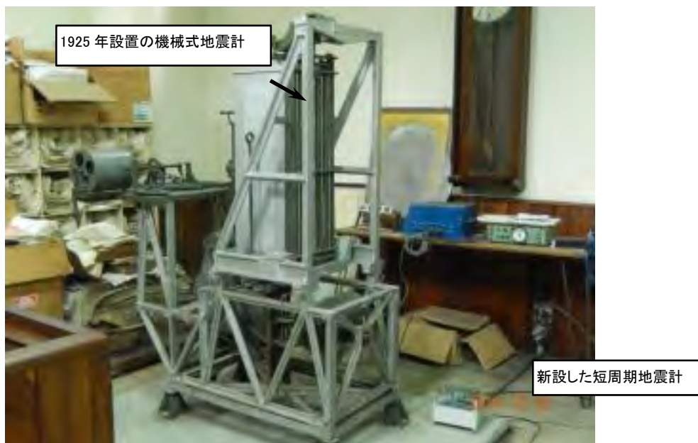
図 2.3.4 IVSIVUMEH 構内に設置した地震計
