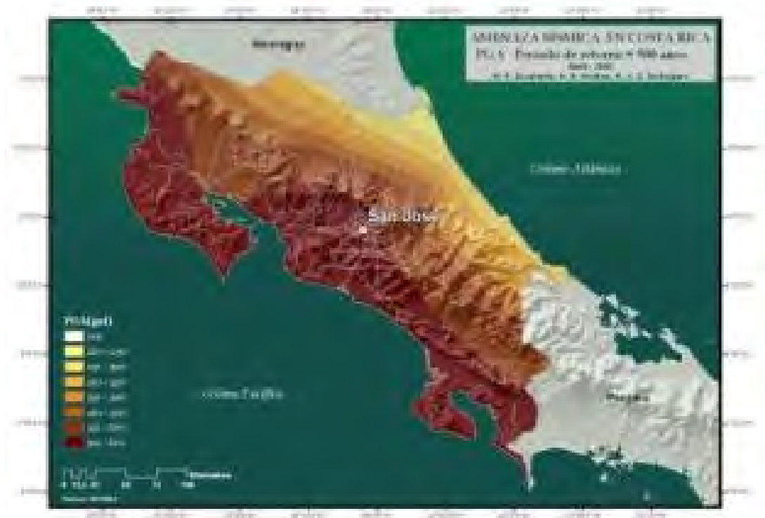
図 2.4.10 RESIS II による地震ハザード解析結果(PGA、再現周期 500 年)(出典: RESIS II 報告書)
