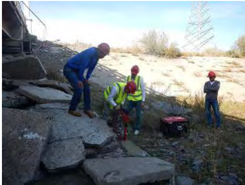
写真 2.4.5 点検機材使用法(コア削孔機)の説明 写真 2.4.6 点検機材使用法(点検用カメラ)の説明
