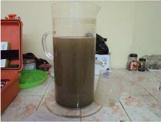
写真 - 3 : 高濁度の白ナイル川原水。
