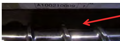
Ampliación de los canales de husillo
