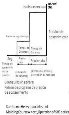
Dibujo- 3: Ejemplo del control de múltiples velocidades y presiones del sostenimiento de presión Mitsuru Sakakibara, Trabajo de moldeo, páginas 185 a 186 (2011), Nikkan Kogyo Shinbun sha
