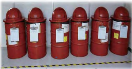
Envases de sustancias peligrosas reguladas mediante la hoja de control que indica su contenido.
