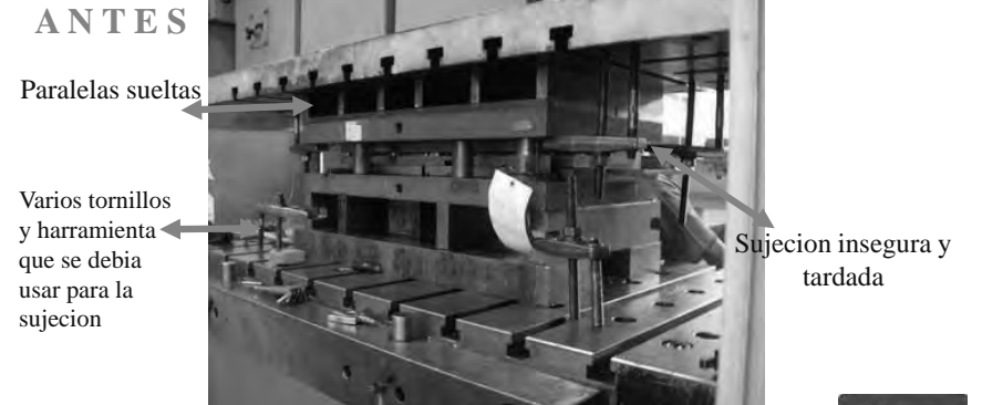
ANTES Paralelas sueltas Varios tornillos y herramienta que se debia usar para la sujecion Sujecion insegura y tardada
