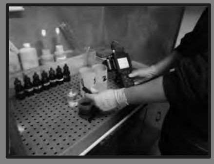
El laboratorista toma la muestra, hace mediciones y ajusta los parámetros del tanque.
