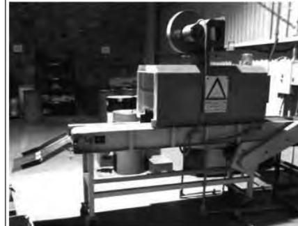
**HORNO DE SECADO PARA VIBRADO**
