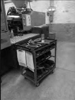
Diseñamos e implementamos el uso de carro para transporte de moldes y herramienta.
