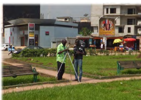
Photographie 18 Vérification de la précision de l'installation du GPS (à gauche), et Vérification de la précision de la mesure d'excentricité (à droite)
