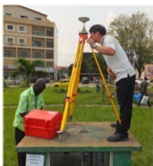
Photographie 18 Vérification de la précision de l'installation du GPS (à gauche), et Vérification de la précision de la mesure d'excentricité (à droite)
