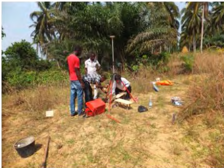
Levé de Point de Calage au Sol (création des balises et observation GPS)
