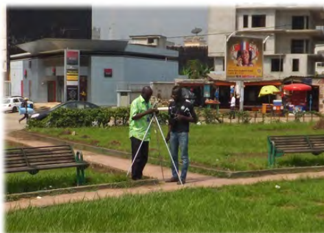
Photographie 9 Vérification de la précision de l'installation du GPS (à gauche), et Vérification de la précision de la mesure d'excentricité (à droite)
