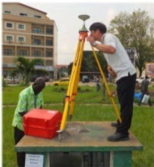
Photographie 9 Vérification de la précision de l'installation du GPS (à gauche), et Vérification de la précision de la mesure d'excentricité (à droite)
