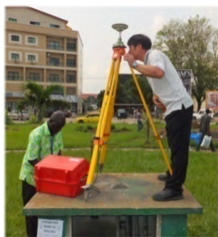
写真 18 GPS 機器設置の精度確認（左）と偏心測定の精度確認（右）
