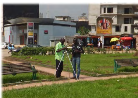
写真 18 GPS 機器設置の精度確認（左）と偏心測定の精度確認（右）
