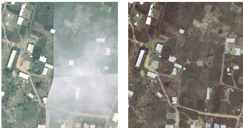
図 44 修正前オルソフォト画像（左）と修正後オルソフォト画像（右） （出所：調査団）
