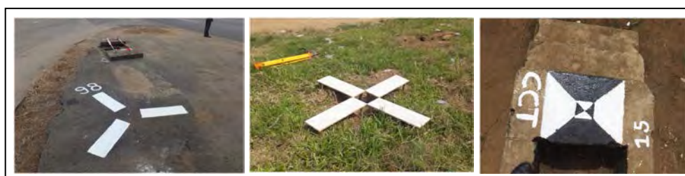
写真 15 対空標識の様式（A型、B型、C型）
