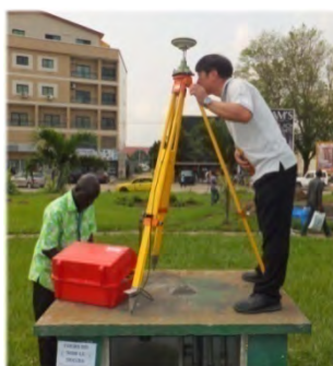
写真 9 GPS 機器設置の精度確認 (左) と偏心測量の精度確認 (右)
