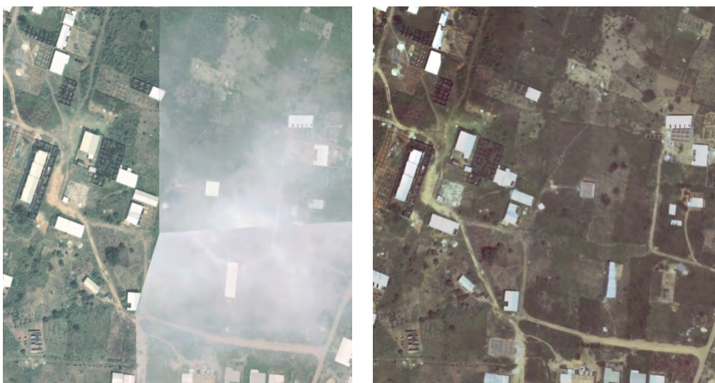
図 29 修正前オルソフォト画像 (左) と修正後オルソフォト画像 (右) (出所：調査団)
