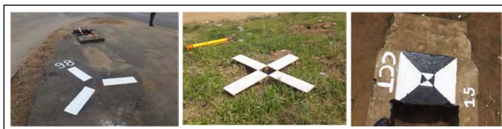
写真 6 対空標識の様式 (A 型、B 型、C 型)
