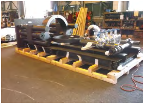
写真 9 : 元押ジャッキ
