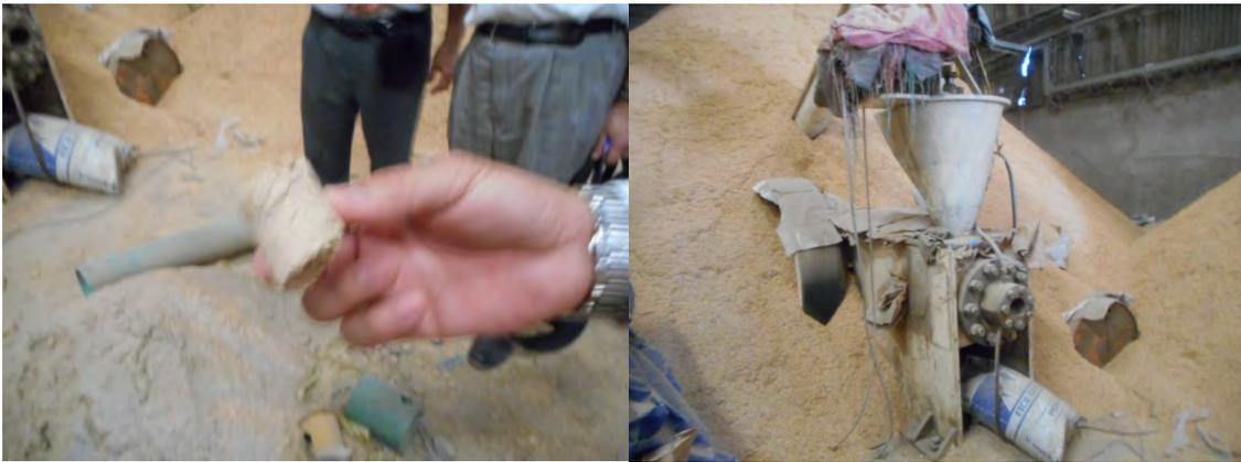
製造された燃料棒のかけら（左）、燃料棒製造装置（右）
