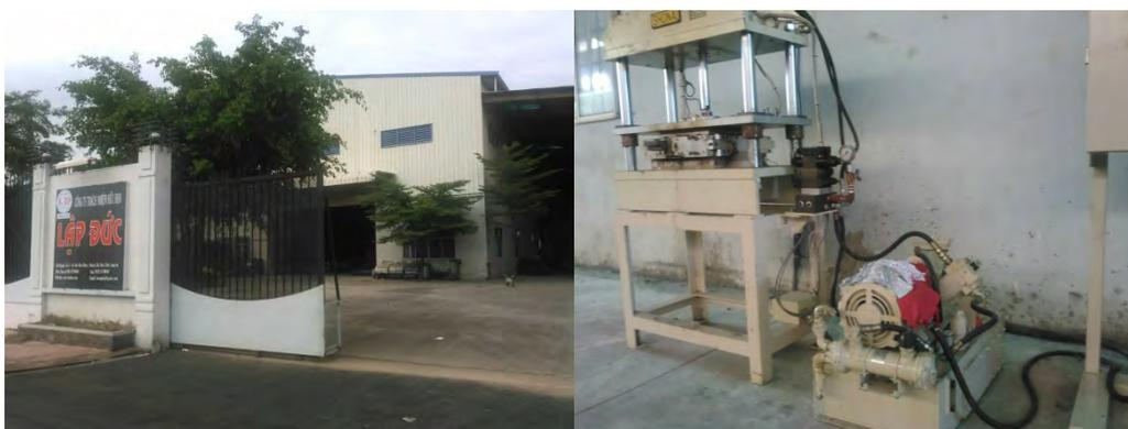
LapDuc 社正門（左）と同社工場内に設置された小型籾殻ボード製造装置（右）
