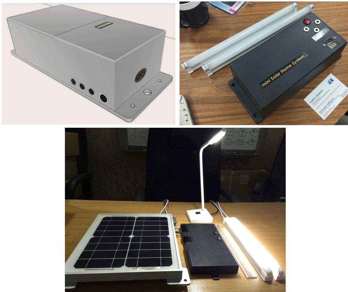
図 1 ミニ SHS コントローラー最終版イラスト、プロトタイプ機と
