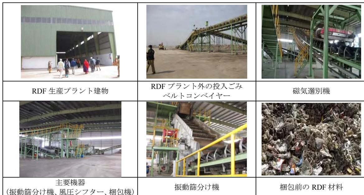
写真 2.5.4 RDF プラントの設備機材 (D. G. ハーン・セメント会社の操業状況)
