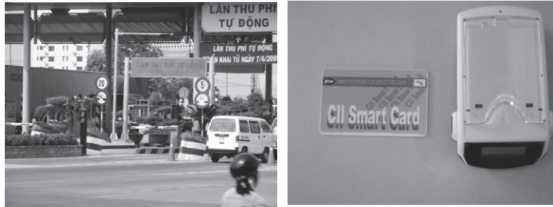
Hình 5.38 Các làn Thu phí và OBU bằng Thẻ IC tại Đại lộ Hà Nội, thành phố Hồ Chí Minh
